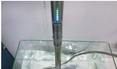
音圧計を使用し、超音波の効果をLEDライトで10段階表示(見える化)します。
