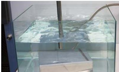
28KHz～200KHzまでを用意し、製品や治具に見合った周波数での洗浄を提案します。
