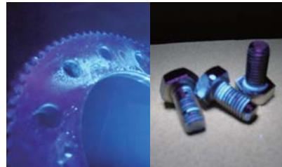
ブラックライトを使用し、製品に付着した油分を発色にて確認しながら、最適な洗浄条件を確立します。
