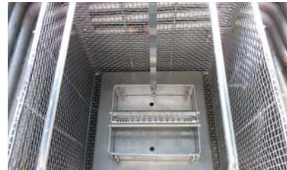
各種溶剤の蒸気を使用し、製品の仕上げ洗浄をおこないます。
