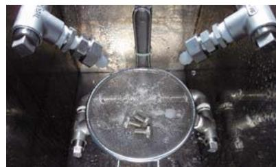
短時間での洗浄は、シャワーを使用し汚れを除去します。
